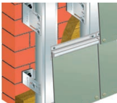
PRIZNANÉ PREKLADANÉ UPEVNENIE LAMINÁTOVÝCH PANELOV (HPL) NITOVANÍM K PODPORNEJ HLINÍKOVEJ KONŠTRUKCII
